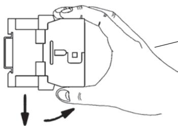
Отсоединение контактора от DIN-рейки без инструментов
