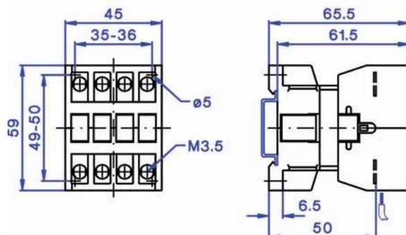
Размеры для контакторов с тепловым реле
